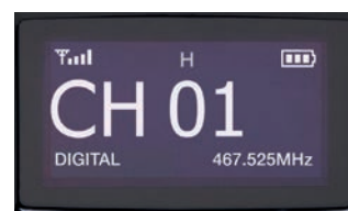
Affichage informatif qui indique à la fois le numéro de canal et la fréquence
